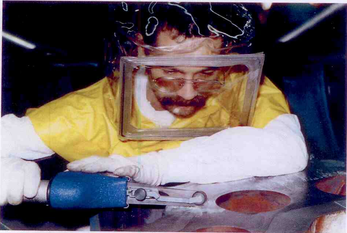
Het voorbereiden van het deelvlak van het hogedruk turbinehuis.
